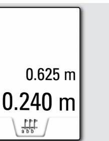
Bei einer Entfernung von weniger als 0.1 m zum nächsten Absteckpunkt beginnt das Gerät zu piepen. Diese Funktion kann durch Drücken der Taste CLEAR/OFF beendet werden.
