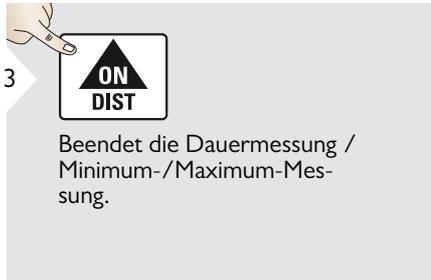
Beendet die Dauermessung / Minimum-/Maximum-Messung.
