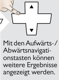
**i** Das Ergebnis wird in der Hauptzeile angezeigt. Drücken der Messtaste für 2 sec in dieser Funktion aktiviert automatisch die Minimum-/Maximum-Messung.
