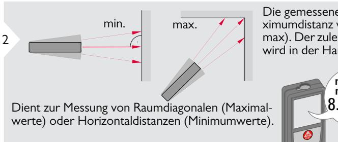
Die gemessene Minimum- und Maximumdistanz wird angezeigt (min, max). Der zuletzt gemessene Wert wird in der Hauptzeile angezeigt.
