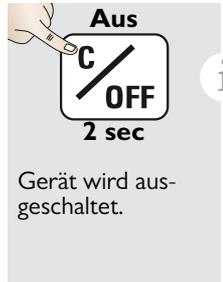
**i** Taste On 2 sec drücken, um den kontinuierlichen Lasermodus zu aktivieren. Wird 180 sec lang keine Taste gedrückt, schaltet sich das Gerät automatisch aus.
