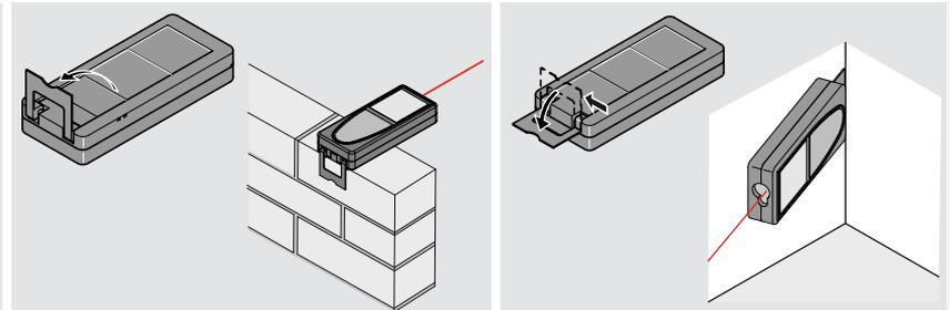
**i** Die Ausrichtung des Endstücks wird automatisch erkannt und der Nullpunkt entsprechend angepasst.
