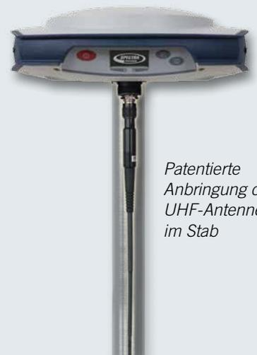
*Patentierte Anbringung der UHF-Antenne im Stab*
