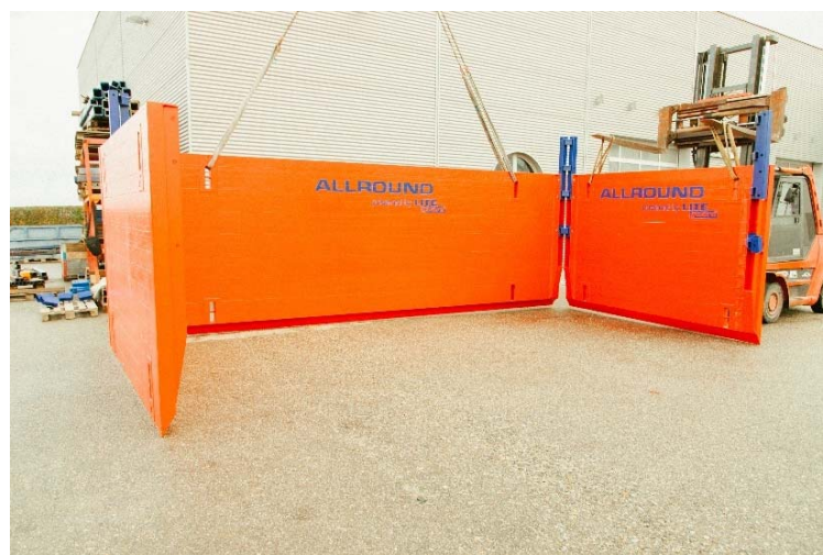
ALU šachtové paženie (dĺžka 7200 x šírka 3600 x výška 4800) pri hmotnosti len od 6 ton.
